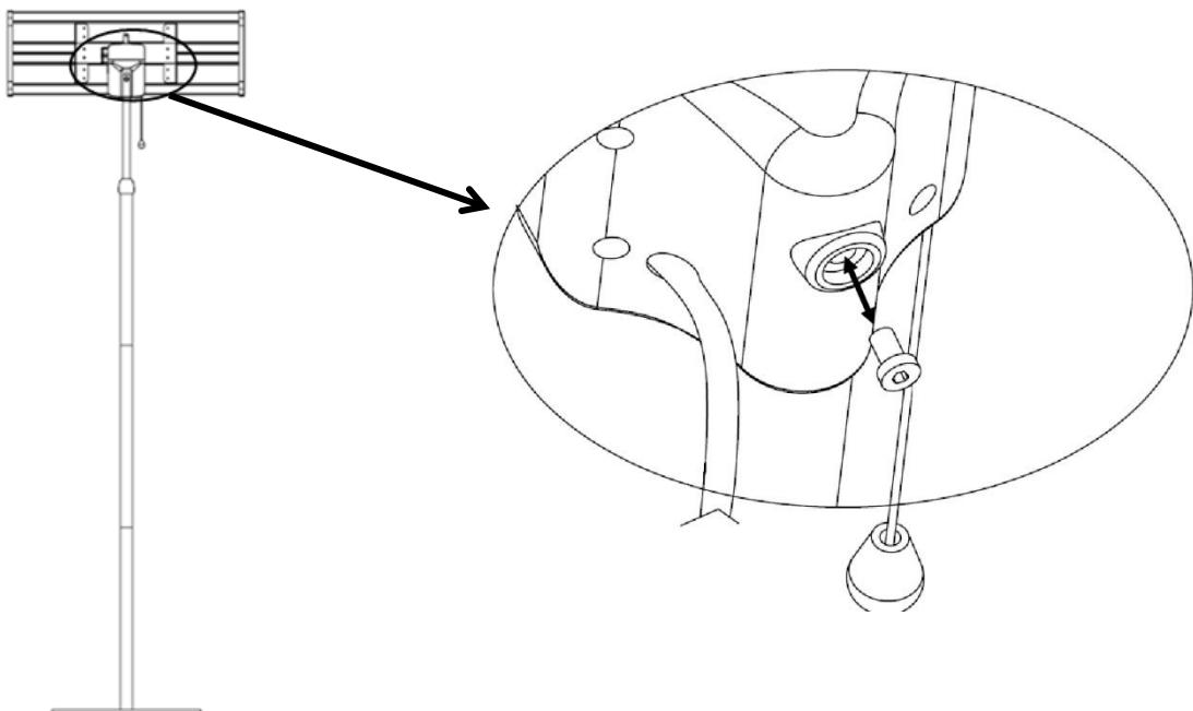
1.6. Assicurarsi sempre che la testa di riscaldamento sia in posizione orizzontale prima di avviare l'apparecchio!
